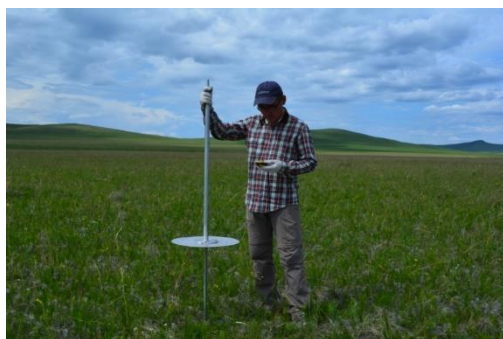
Зураг 2. Дорнод аймгийн Баяндун сумын хээр диск хэлбэрт хэмжигчээр хэмжилт хийж буй нь
