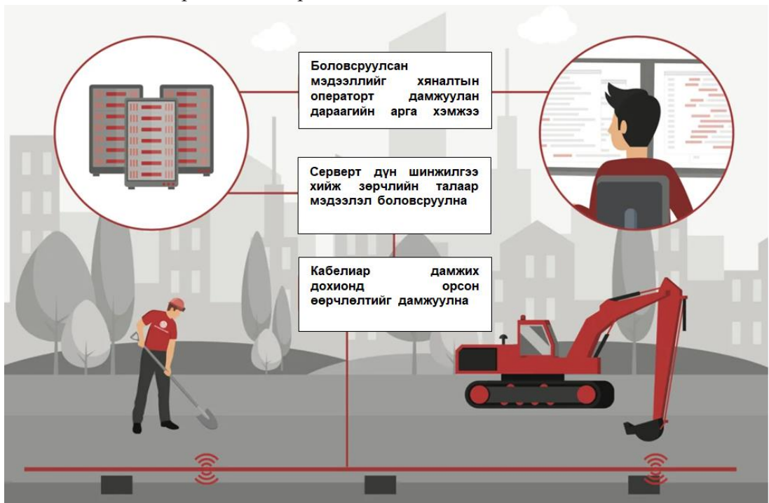
Зураг 1. Шилэн кабелийн дохиоллын системийн ажиллагааны тойм зарчим
